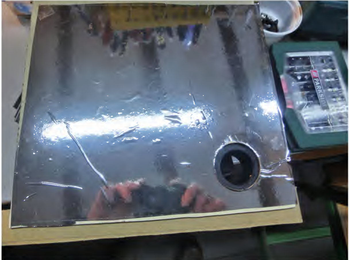
Deckplatte mit Austrittsstutzen (mit 3-D-Drucker gedruckt)
