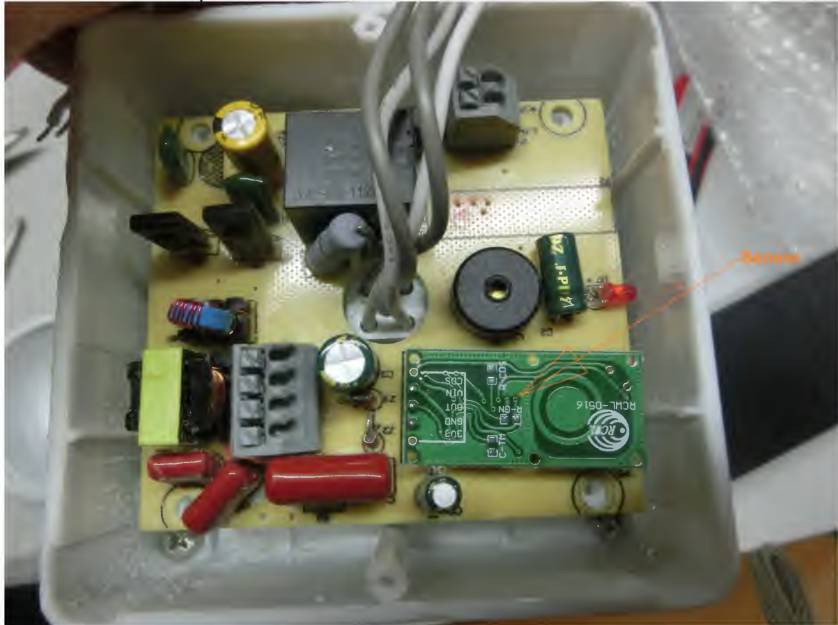
Stirnseite 12W-Lampe mit auszubauendem Sensor
