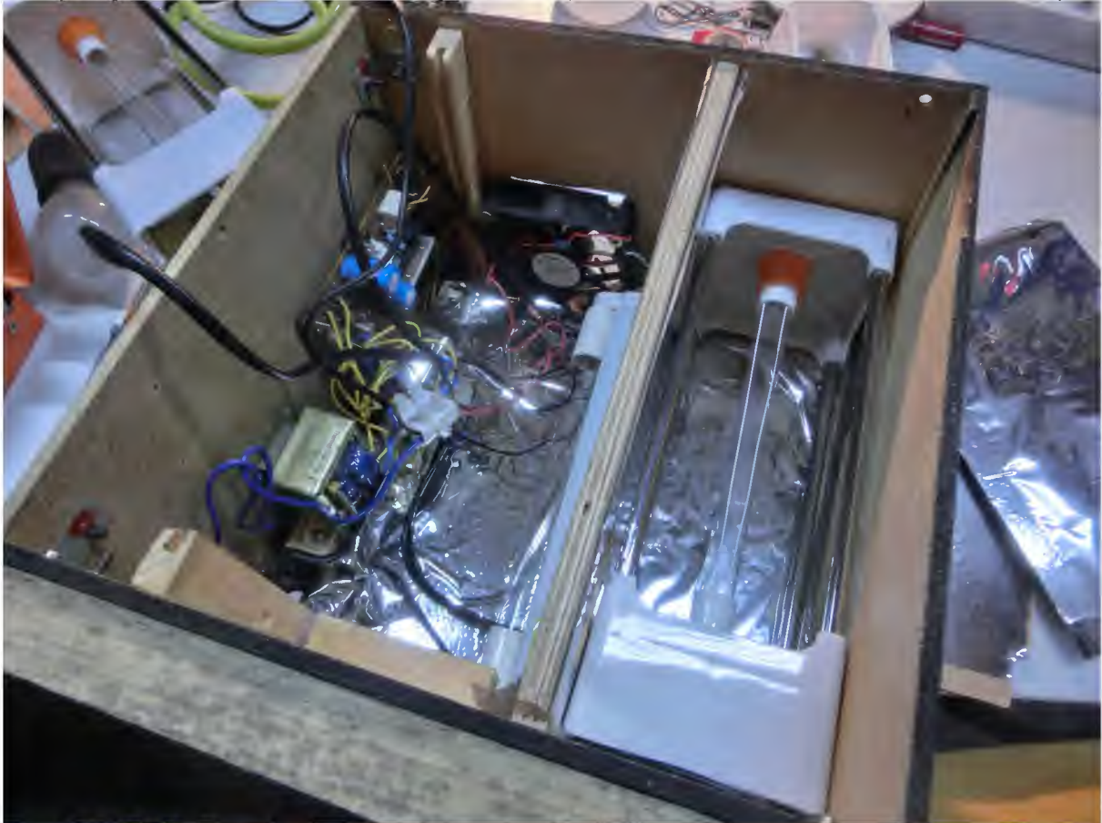
Lampengehäuse mit Stromversorgung (12V) für den Lüfter, rechts 12W UVC-Lampe
